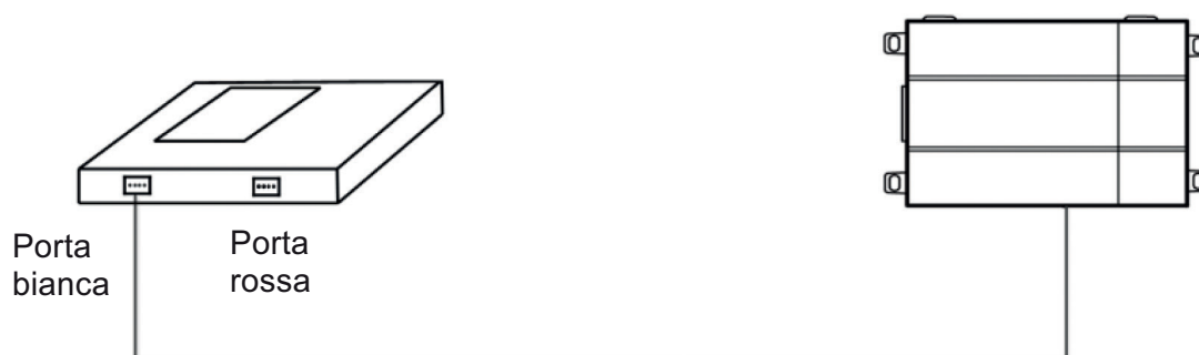
Fig. 7.8 Connessione del cavo di comunicazione tra Controller e Filocomando del Water Heater
