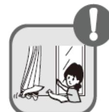
In caso di perdita di refrigerante durante l'installazione, ventilare immediatamente l'area. Nel caso il gas refrigerante entri in contatto con fiamme libere, si sprigioneranno gas tossici.
