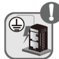
Assicurarsi che l'unità possa essere correttamente e saldamente collegata a terra dopo l'inserimento nella presa al fine di evitare eventuali scariche elettriche. Non collegare il cavo di messa a terra a tubi del gas, condotte dell'acqua, parafulmini o linee telefoniche.
