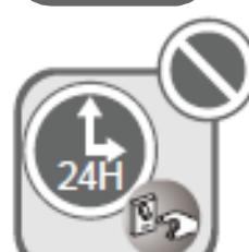
Collegare l'unità all'alimentazione di rete 8 ore prima di metterla in funzione. Accenderla 8 ore prima dell'avvio. Non scollegare l'alimentazione in caso di arresto breve di 24 ore (per proteggere il compressore).
