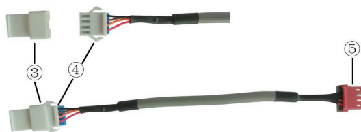
Fig. C: Schema del cavetto adattatore: il terminale ③ è il terminale di protezione; collegare il terminale ④ al terminale ② del cavo di collegamento; collegare il terminale ⑤ al terminale del Filocomando del Condizionatore.
