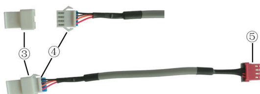
Fig. 24 Schema del cavetto adattatore: il terminale ③ è il terminale di protezione; collegare il terminale ④ al terminale ② del cavo di collegamento; collegare il terminale ⑤ al terminale del Filocomando del Condizionatore
