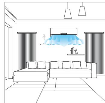
L'oscillazione verticale automatica delle alette di mandata dell'aria consente un'ottima distribuzione dell'aria nell'ambiente. Inoltre la possibilità di settare da telecomando diversi livelli di velocità della ventola consente di raggiungere la temperatura desiderata, a seconda delle esigenze, in tempi ridotti o con la minima rumorosità.
