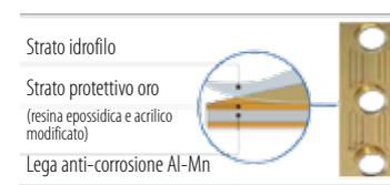
Il rivestimento delle alette dura nel tempo e garantisce una resistenza alla corrosione salina, superiore del 200%-300% rispetto a quella che caratterizza le componenti comunemente utilizzate.
